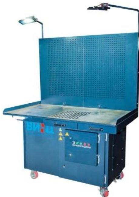
Стол представляет собой эргономичное рабочее место со столешницей и задней перфорированной панелью. Столешница установлена на фильтровально-вытяжном модуле ВАУ МТ «КАМА» 1500. Загрязненный воздух отводится непосредственно в модуль, где очищается от механических примесей. Очищенный воздух подается обратно в помещение. Фильтровально-вытяжной модуль оснащен встроенным ЕС-вентилятором с регулировкой оборотов, патронным фильтр-элементом с автоматической системой регенерации.
